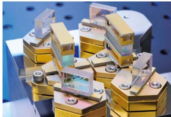
Bild 1: Mechanisch stabiler, optisch parametrischer Oszillator. (Quelle Fraunhofer ILT)
