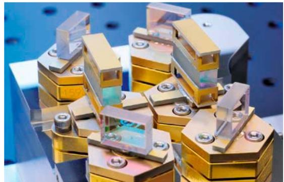
Bild 1: Mechanisch stabiler, optisch parametrischer Oszillator. (Quelle Fraunhofer ILT)
